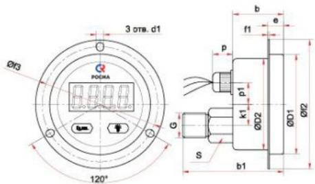
Эксцентрическое присоединение с передним фланцем (Ø63 мм)
