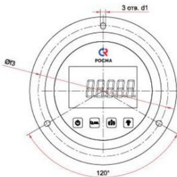
Эксцентрическое присоединение с передним фланцем (Ø100 мм)
