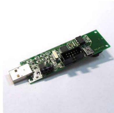
Базовый модуль для разработки собственных устройств типа "Умный дом", сопряженных через порт USB с PC на Windows или с Андроид устройством не ниже 3.1 и подключенным портом OTG. Модуль содержит часы реального и датчик температуры, которые позволяют создать Хроностат (термостат с расписанием необходимой температуры), термостат, таймер. После настройки (передачи команд управления в модуль) встроенные часы реального времени позволяют прибору работать автономно.
