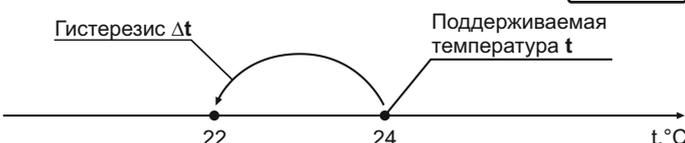
При этом нагреватель, управляемый терморегулятором, будет нагревать помещение до 24 °С и отключаться. После остывания помещения на 2 °С (до 22 °С), терморегулятор снова включит нагреватель и цикл повторится.
