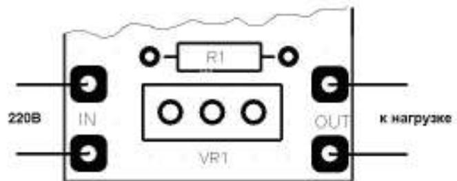
**Рис.4. Подключение устройства**
