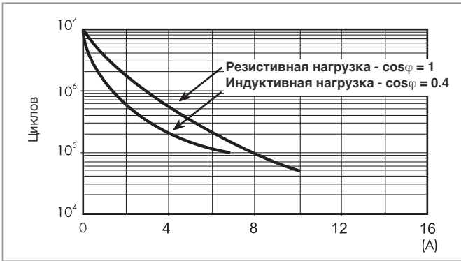
F 36 - Электрическая долговечность (АС) при ном. нагрузке
