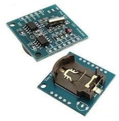
DS1307 I2C real time clock chip (RTC)
