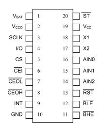
20-Pin TSSOP (4.4mm) 20-Pin SOIC (300 mil)
