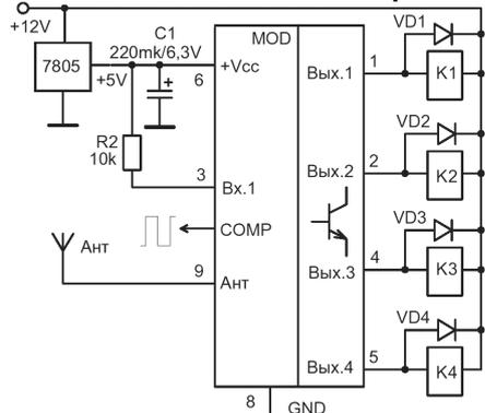
Рис.8 Схема включения приемника с открытым коллектором
