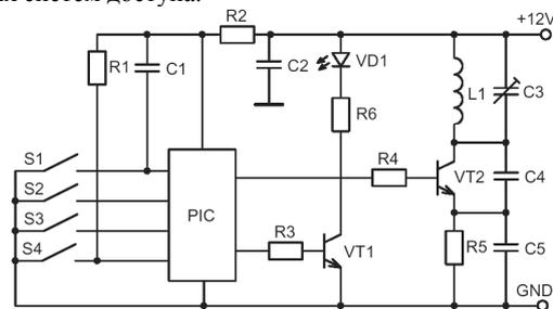
Рис.3 Схема электрическая принципиальная передатчика
