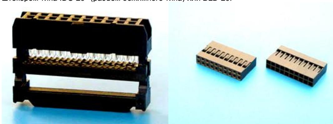
Рис. 11 Внешний вид разъема IDC-20 (слева) и BLD-20
