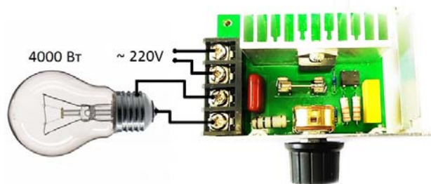
Вид изнутри и схема подключения. Рис. 2
