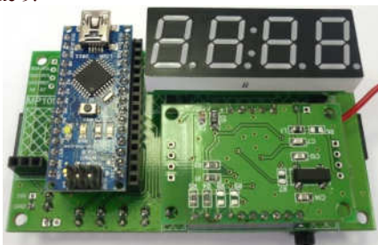
Рис. 9 Базовая плата с установленными модулями
