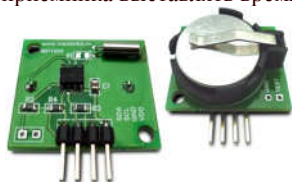
Рис. 28 Часы реального времени MP1095
