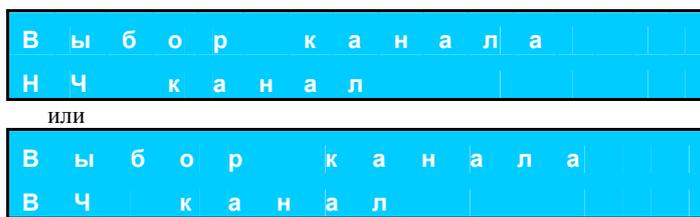
В рабочем режиме переключение на ВЧ канал осуществляется нажатием и удерживанием кнопки “Кнопка <<”, на НЧ канал – кнопки “Кнопка >>”.
