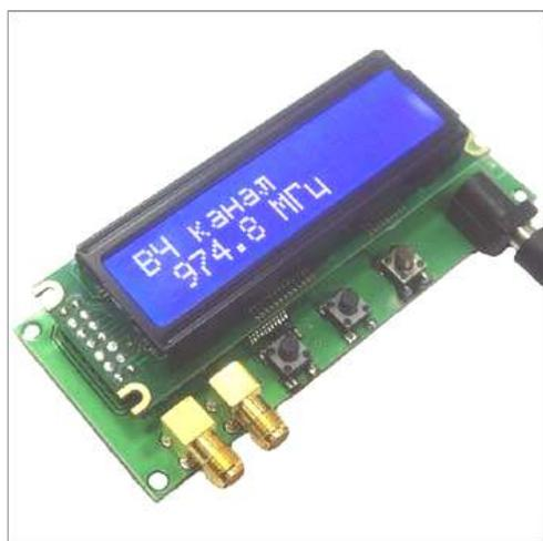
Рис.1. Общий вид частотомера
